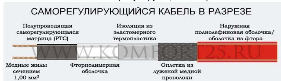
**Состав Саморегулирующегося нагревательного кабеля**
